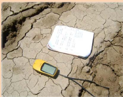
Receptor de GPS y cuaderno de campo, para el relevamientos de datos durante el monitoreo
